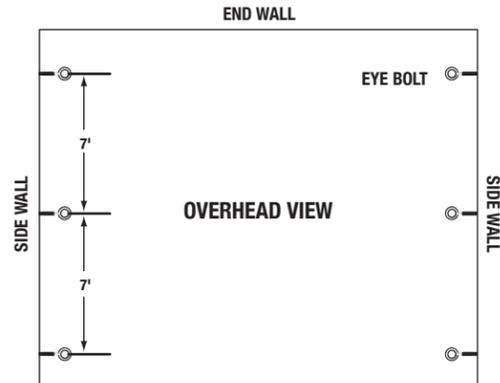
**2. SIDEWALL VIEW: EYE BOLT POSITIONING**
