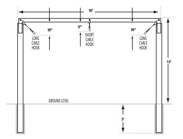
**3.** OVERHEAD VIEW OF WHERE TO DIG HOLES FOR THE GROUND SLEEVES.
