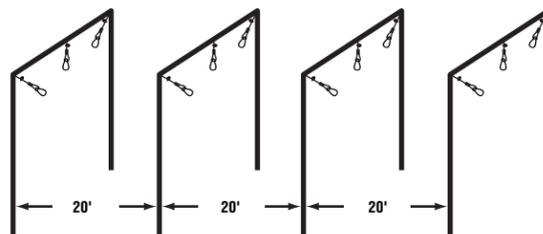
**5.** SIDE VIEW OF NET COMPLETELY SET UP
